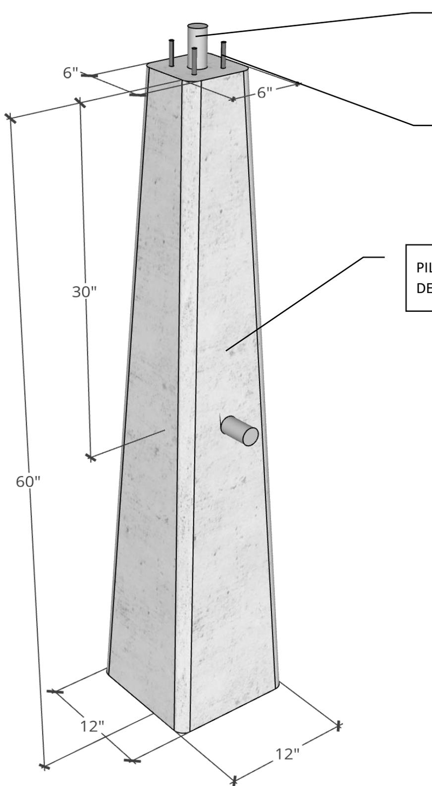
TUYAU DE PVC Ø 1" POUR LE PASSAGE DE FILS ÉLECTRIQUES SOUS-TERRAIN VERS LA BOÎTE ÉLECTRIQUE.
